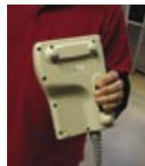
Drei-Stufen-Zustimmungsschalter für alte und neue Programmierereinheiten.
