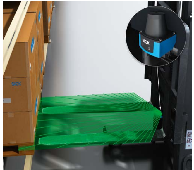
Erkennen von leeren Fächern in einem Hochregallager.
