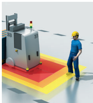
S300 Mini Remote zur Absicherung von AGVs
