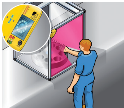
Gefahrstellenabsicherung an einem halbautomatischen Montageautomaten
