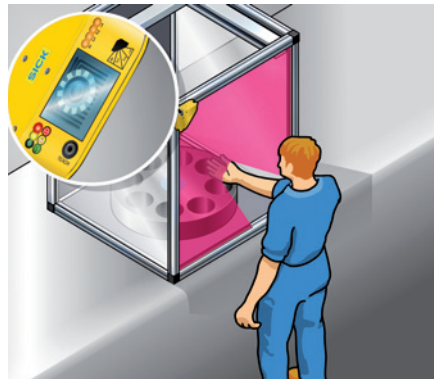
Gefahrstellenabsicherung an einem halbautomatischen Montageautomaten
