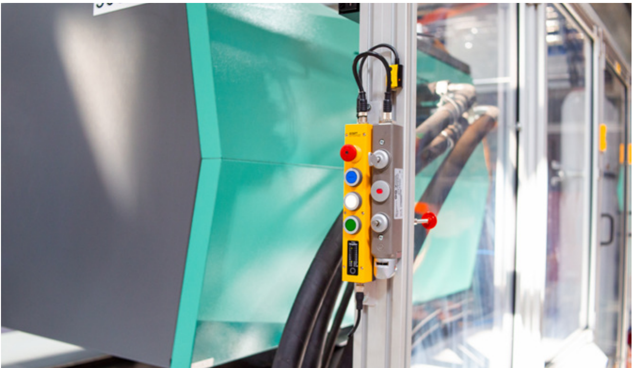
Safety Simplifier mit Euromap-Schnittstelle an einer Spritzgussmaschine.
