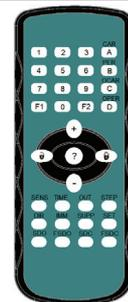
Für die drei verfügbaren Einstellungsmethoden (RMS Remote Control, Tasten, RADAR-RC-Fernbedienung) werden im Radarsensor jeweils getrennte Parameterbereiche verwaltet. Somit gehen Einstellungen, die mittels Tasten vorgenommen wurden, nicht verloren, wenn zwischenzeitig mittels DIP 6 auf einen Fernbedienungsmodus gestellt wurde. Andererseits kann man z. B. keine Einstellungen mit einer Fernbedienung auslesen, die mit den Tasten gemacht wurden.
