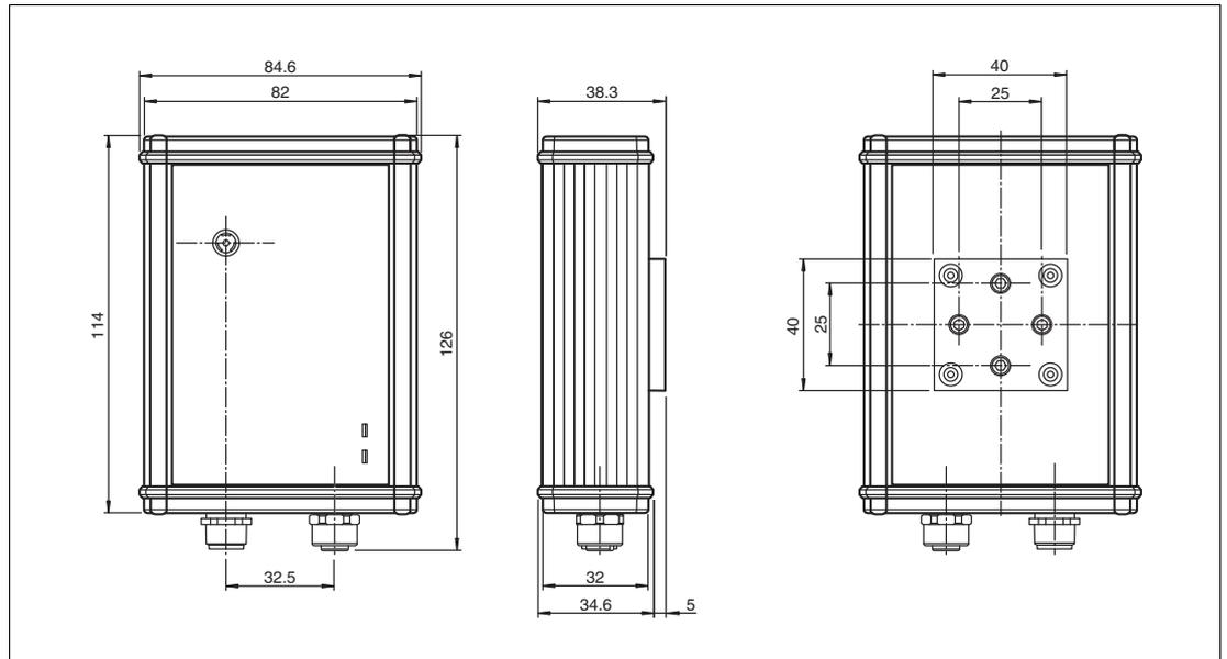
Abbildung 2.5 Gehäuseabmessung
