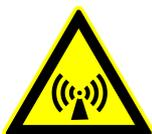
Das Symbol **Warnung vor elektromagnetischem Feld** weist auf die Vorsichtsmaßnahmen bei der Handhabung von Komponenten hin, die im Betrieb elektromagnetische Felder erzeugen (Funksendeanlage). Bei Arbeiten an diesen Komponenten sind diese außer Betrieb zu setzen.
