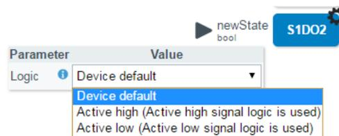
Die einzelnen Digitalausgänge an den Anschlüssen S1 bis S6 können entweder als „Active high“ (Aktiv bei „High“) oder „Active low“ (Aktiv bei „Low“) konfiguriert werden, indem Sie auf das Zahnradsymbol neben dem Digitalausgangsblock klicken.
