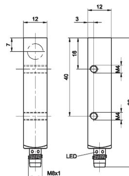
► sensor induktiv, vollmetall
